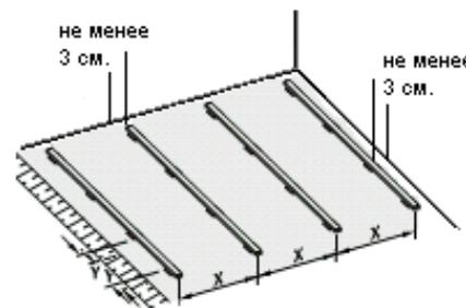
Рис. 5 Укладка с резиновыми прокладками по бетонному полу
